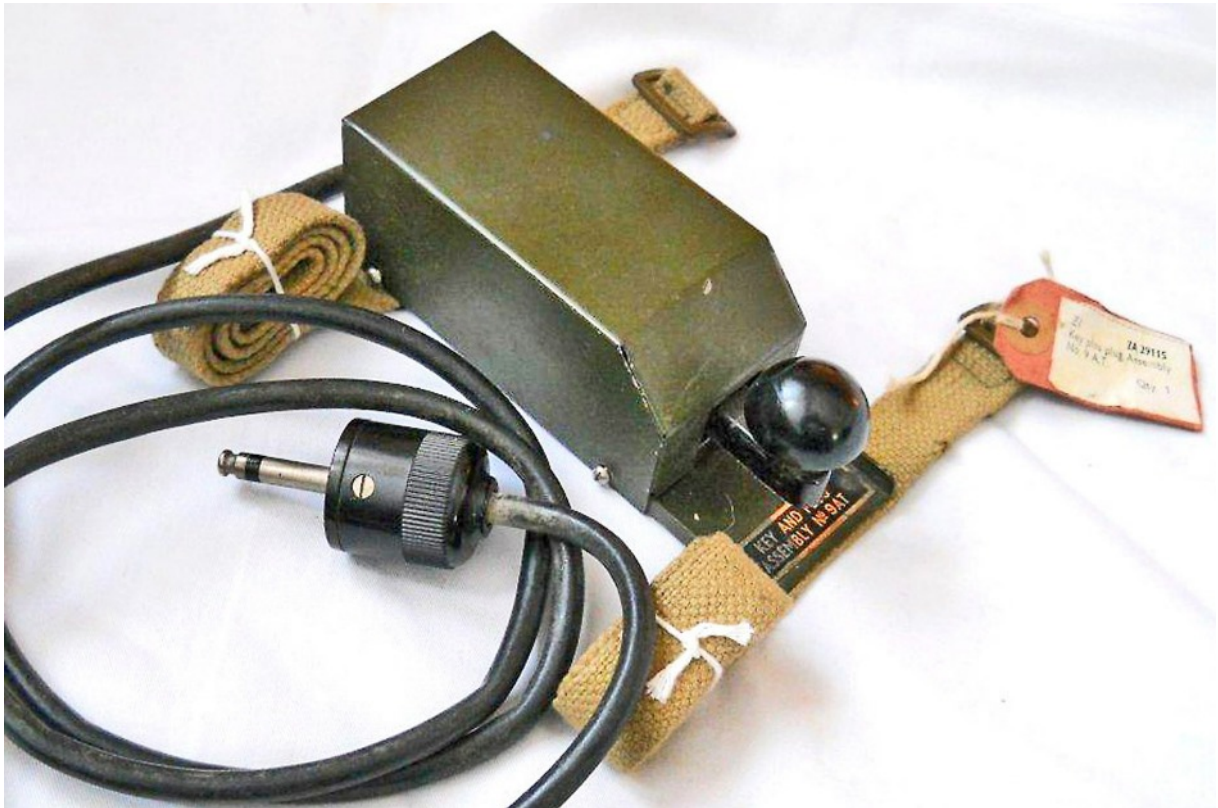
Key and Plug Assembly No. 9AT ver. 4.2.
